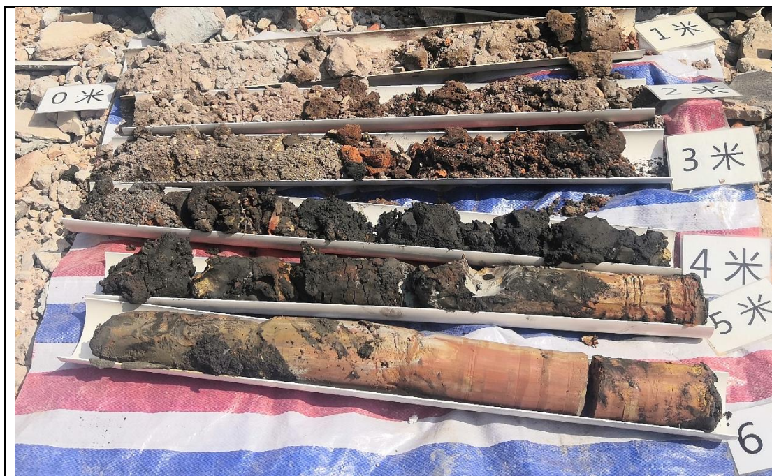
图 3.4-1 土壤超标点位 S2 钻孔岩芯照
