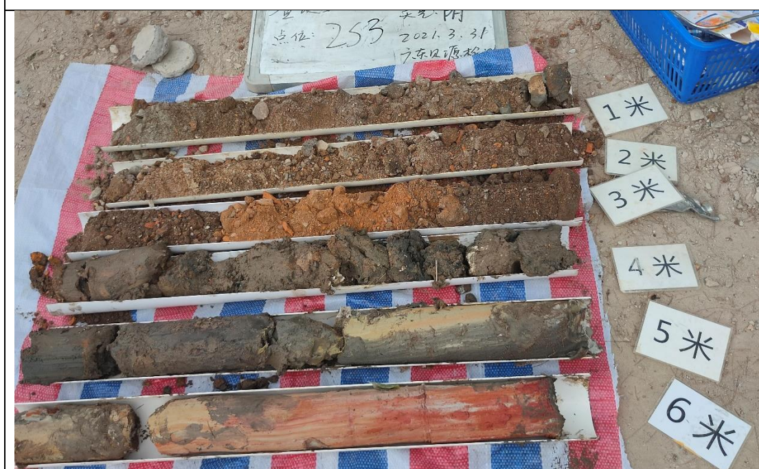
图 3.4-2 土壤超标点位 2S3 钻孔岩芯照
