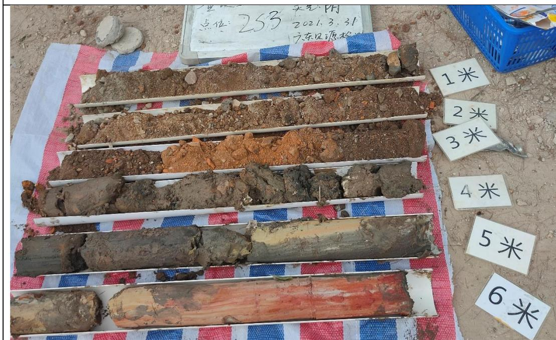
图 6.3-2 土壤超标点位 2S3 钻孔岩芯照
